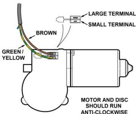
ELEVATION BOX MOTOR
